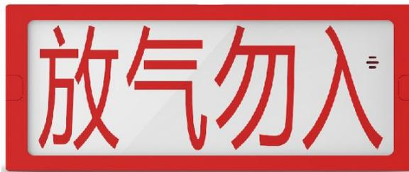
闪动显示“放气勿入”并发出刺耳的声报警信号，提醒现场人员不要进入防护区。气体释放报警器与 JB-QBL-QM200 气体灭火控制盘直接配接，也可通过输出模块与 JB-QBL-QM300、QM6000 气体灭火控制盘配套使用，满足 GB26851-2011 《火灾声和/或光报警器》标准要求。
