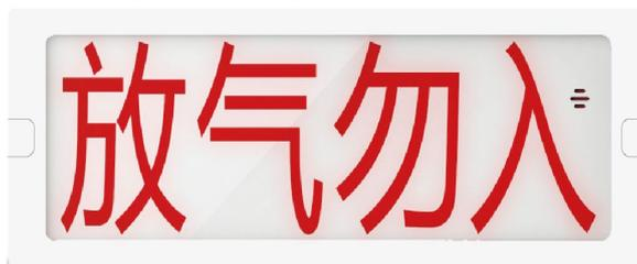
报器会闪动显示“放气勿入”并发出刺耳的声报警信号，提醒现场人员不要进入防护区，气体释放警报器可以分别设置成声、光、声光三种启动方式，满足 GB26851-2011 《火灾声和/或光警报器》标准要求。
