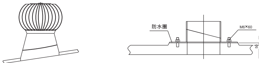
轻钢屋顶装设涡轮排风机（27”）示意图
