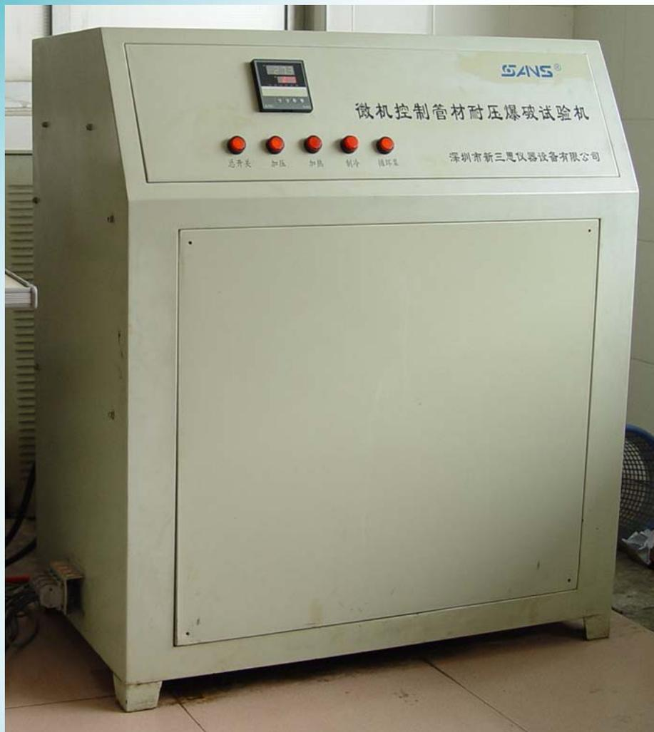
微机控制管材耐压爆破试验机
